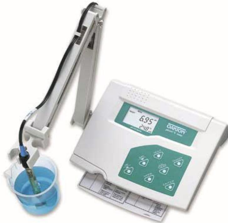
Slika 16: *pH* meter z elektrodo
