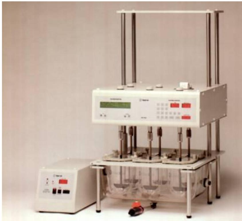
Slika 20: Aparatura za sproščanje z vreteni
